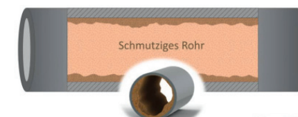
Nach langjährigem Betrieb lagern sich Schlamm und sonstige Schmutzpartikel in den Rohren ab.
